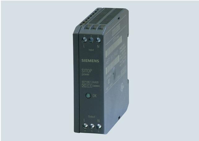
El limitador de corriente de cierre SITOP sirve para reducir con seguridad las corrientes de conexión, p. ej. las que originan transformadores o fuentes de alimentación conmutadas debido al rectificador de entrada con filtro por condensador.
