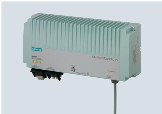
La fuente con grado de protección IP67 SIMATIC ET 200pro PS alimenta la electrónica de control, los sensores y la carga del sistema de periferia SIMATIC ET 200pro para uso sin armario a pie de máquina. Con contacto de señalización para "24 V OK" y "Sobrettemperatura" y un segundo conector para distribuir la tensión de entrada.
