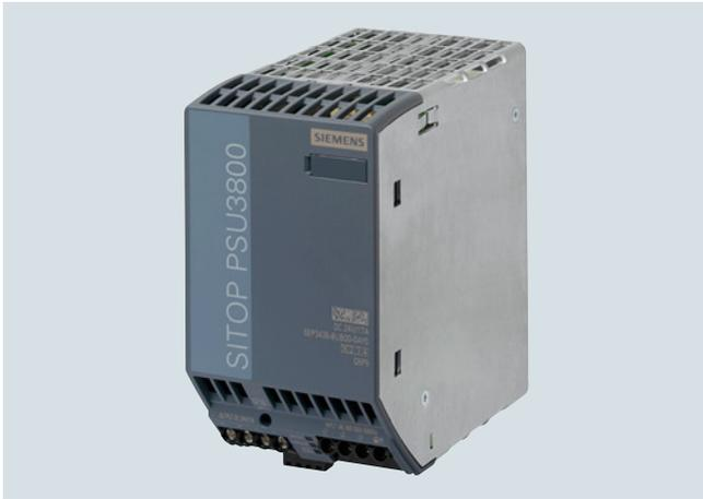
Gracias a la característica de intensidad constante, las fuentes de alimentación trifásicas SITOP PSU3800 (24 V DC/17 A y 30 A) resultan ideales para recargar baterías. Para otras aplicaciones se puede conmutar la característica inicial a corte que exige rearme. La entrada trifásica de rango amplio permite su uso en el mundo entero. Su reducida anchura ocupa muy poco espacio en el perfil DIN. No es necesario dejar espacio en los laterales.
