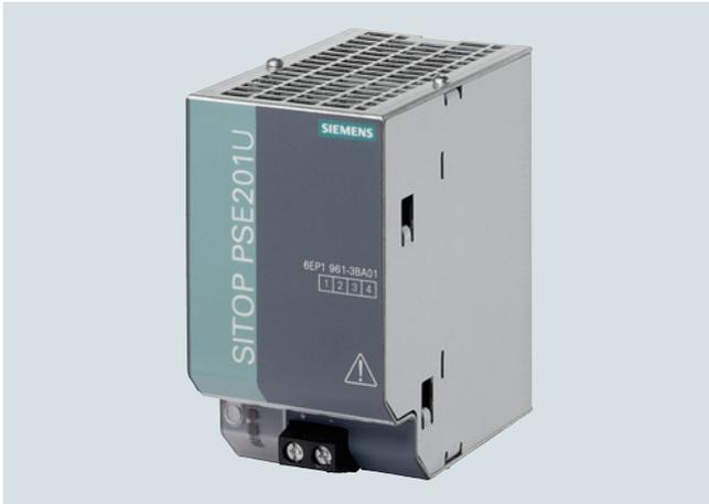
El módulo de respaldo SITOP PSE201U supera caídas de red de corta duración hasta en el rango de segundos y se puede utilizar con todas las fuentes de 24 V de las series SITOP smart o SITOP modular. El módulo de respaldo tiene unos condensadores exentos de mantenimiento que funcionan como acumuladores de energía y asumen automáticamente la tarea de alimentar las cargas con 24 V ante un corte de la tensión de red.
