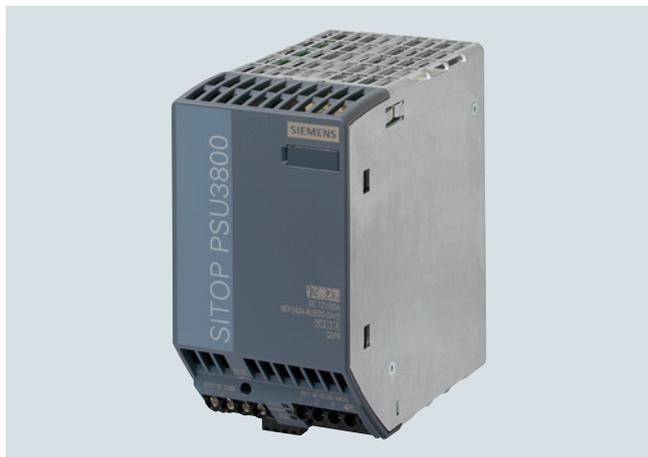
Gracias a la característica de intensidad constante, las fuentes de alimentación trifásicas SITOP PSU3800 resultan ideales para recargar baterías. Para otras aplicaciones se puede conmutar la característica inicial a corte que exige rearme. La entrada trifásica de rango amplio permite su uso en el mundo entero. Su reducida anchura ocupa muy poco espacio en el perfil DIN. No es necesario dejar espacio en los laterales.
