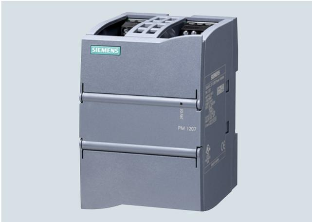
La fuente de alimentación monofásica SIMATIC PM 1207 (PM = Power Modul) dispone de conmutación automática del rango de tensión de entrada y está óptimamente adaptada en diseño y funcionalidad al controlador SIMATIC S7-1200. Éste alimenta CPUs con entrada de 24 V, módulos de señales y cargas de 24 V conectadas a ellos. Numerosas homologaciones como UL, ATEX y DNV GL hacen posible su uso universal.
