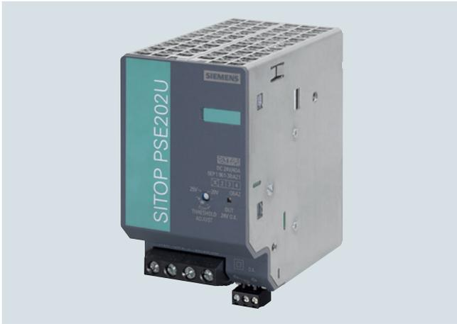
Los módulos de redundancia SITOP PSE202U son el complemento ideal para todas las fuentes de alimentación de 24 V. Con ellos se garantiza una protección adicional ante cortes de la alimentación de 24 V. El módulo de redundancia vigila de forma constante las fuentes y, en caso de fallar alguna de ellas, la otra se hace cargo de la alimentación de 24 V. Adicionalmente se señala el estado con un contacto al efecto que se puede evaluar desde un controlador, un PC o el sistema de control de procesos.
