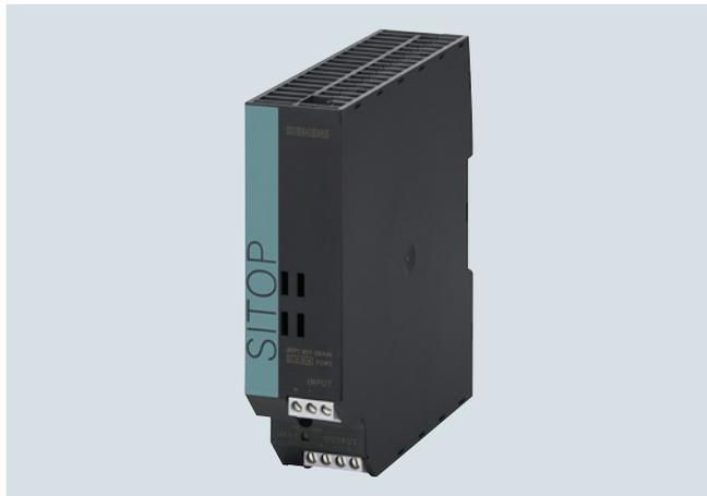
Convertidor DC/DC para conectar con cableado fijo a redes de corriente continua con tensión de 24 V. Tensión de salida 12 V DC, aislada galvánicamente, a prueba de cortocircuitos y marcha en vacío.
