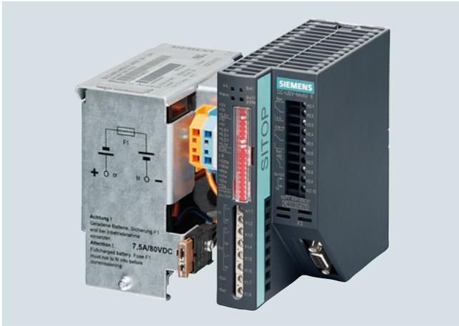
Combinando un módulo DC-USV con un módulo de batería de 24 V y una fuente SITOP como mínimo, se pueden puentear cortes prolongados de la red de forma absolutamente ininterrumpida. Aunque se requiera una intensidad de respaldo mayor, la fuente SAI con baterías de plomo sin mantenimiento ofrece máxima seguridad, pues es capaz de superar fallos de red hasta en el rango de horas suministrando hasta 40 A.
