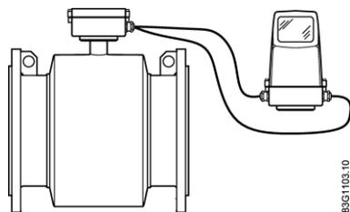
Figura 4-2 Instalación remota
