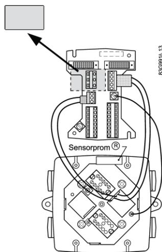
7. Introduzca los cables de alimentación y de salida a través de prensaestopas y conéctelos a la placa de conexiones como aparece en Conexión eléctrica (Página 36).
