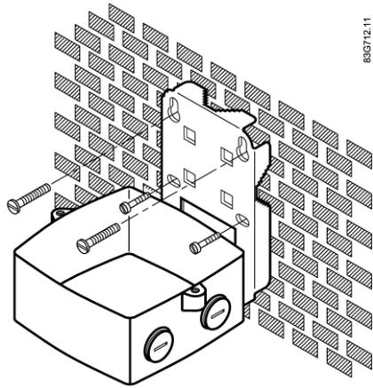
Figura 4-6 Montaje en la pared
